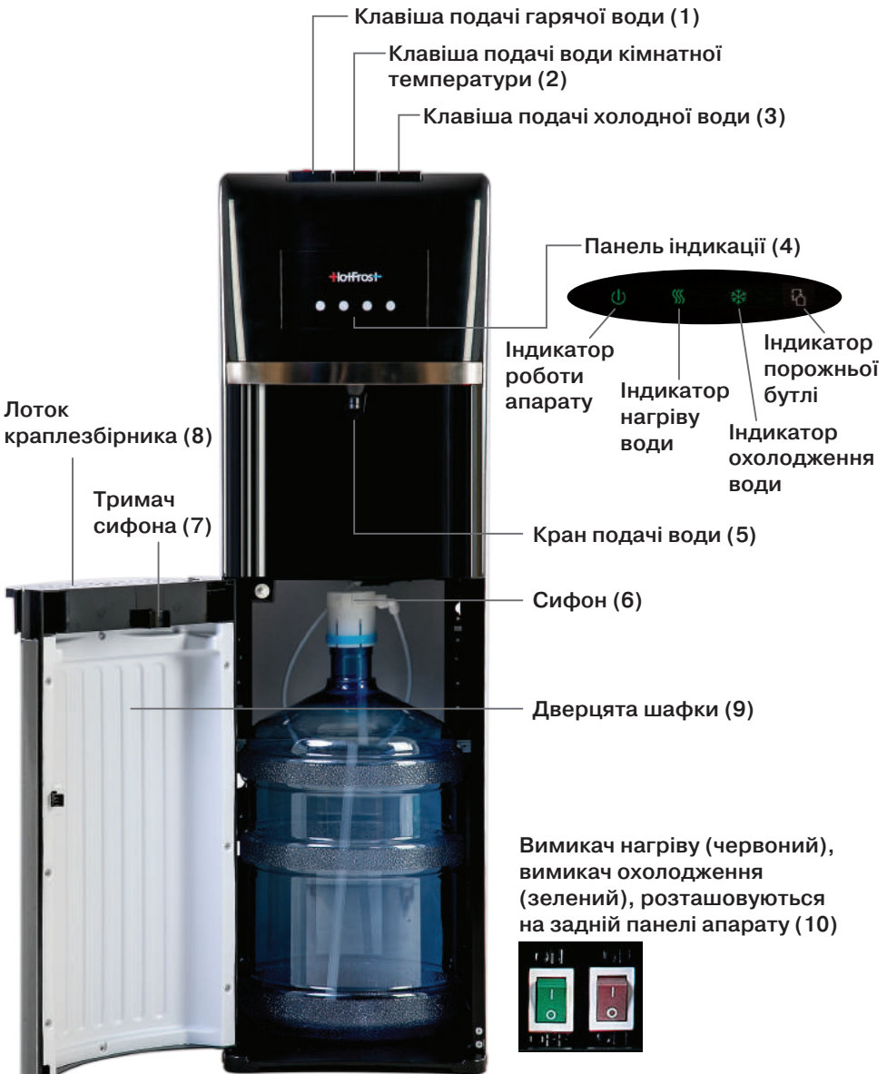
Мал. 1. Схема апарату 35AEN
