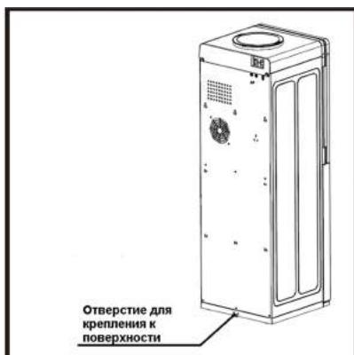
Рис. 2. Фиксация аппарата
